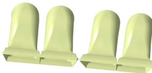
图7 两套并列双发三维非对称多S弯喷管
